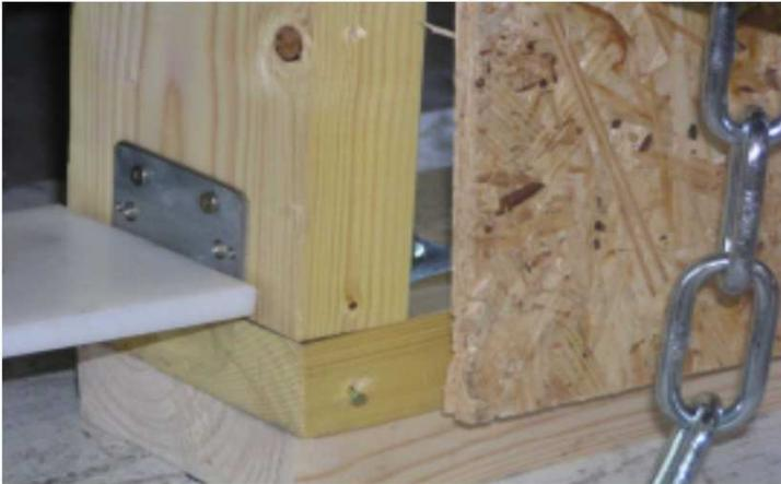
Rupture par rotule plastique des pointes
